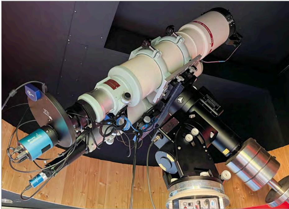
Takahashi-Refraktor mit Rotator und Filterrad für die Astrofotografie in unterschiedlichen Lichtfrequenzen
